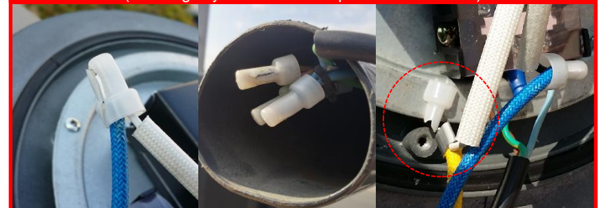
경화에 의한 캡 커버 분리되어 누전 및 불량발생 (Breakage by Hardened Compression Terminals)
