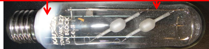
부적합 안정기 사용에 의한 폭발과 공기유입에 따른 산화 (Explosion and oxidation due to air flow by inappropriate ballast)
