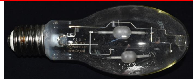
누전 및 계속적인 저압점등에 따른 프레임 용단 (Blow lamp frame of the short circuit and continuous low-voltage Ignition)
